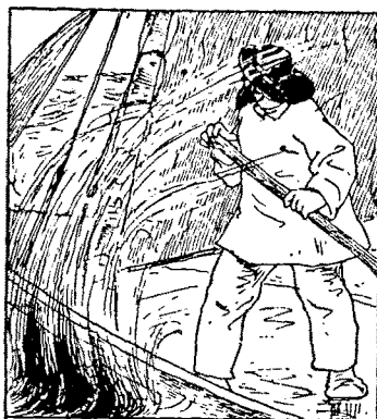
2. Le caoutchouc dissous dans l'essence de térébenthine donne un vern is que l'on étend sur les chapeaux, les tissus pour les rendre imperméables *.
