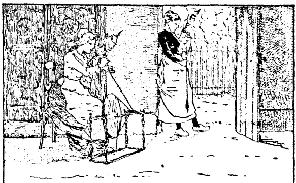
11. On tord la filasse au moyen du rouet ou du fuseau , et on a un fil de chanvre.
