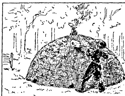
24. Charbonnier faisant une meule pour la fabrication du charbon de bois. Il recouvre sa meule de terre humide.
