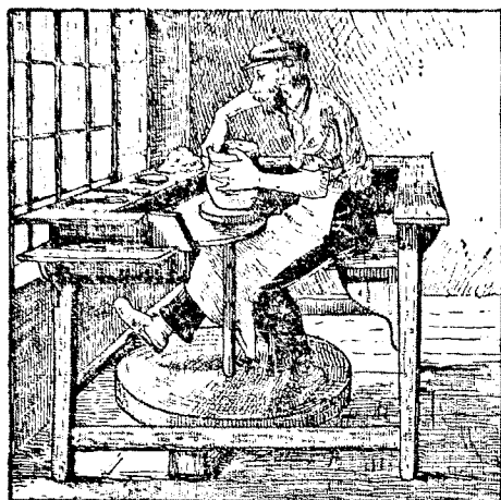
55. Le potier façonne la pâte d' argile sur un tour* qu'il fait mouvoir avec le pied.
