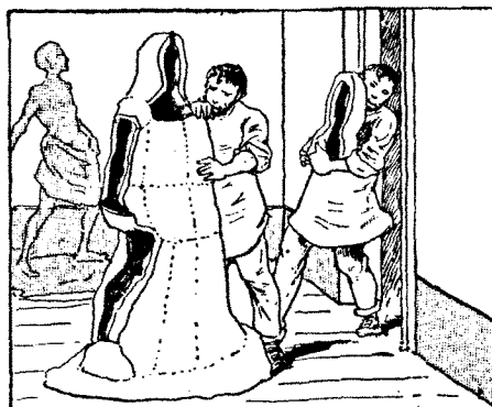
86. On retire la statue du moule et on remonte toutes les pièces du moule dans lequel on coule du plâtre liquide.
