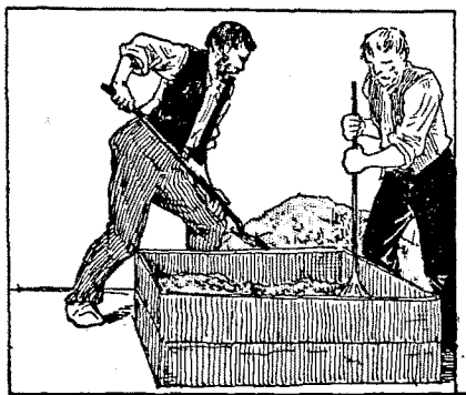
9. Ouvriers tassant du sable dans le deuxième châssis.
