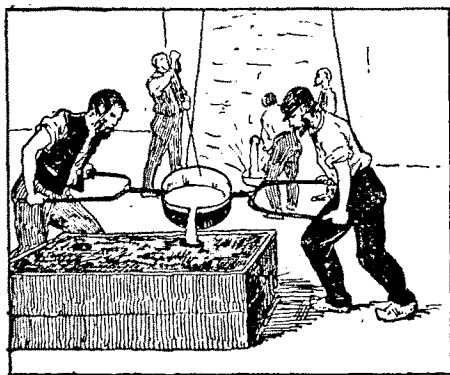
11. Les deux châssis remis en place, on verse de la fonte * dans l'espace laissé vide par l'enlèvement du modèle en bois.
