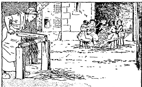
9. L'opération qui consiste à détacher les fibres est le teillage . On obtient ainsi de la filasse .
