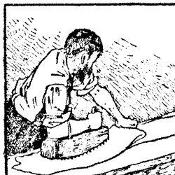
44. Le corroyeur assouplit les cuirs mous tout en leur conservant leur fermeté.
