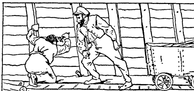
22. On prévient les éboulements en soutenant par des charpentes ou étais les parois et le plafond des galeries. C'est ce qu'on nomme le boisage .
