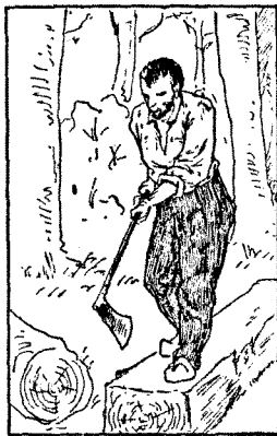
46. Équarreur équarissant une poutre.
