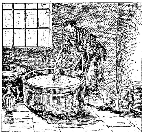
57. L'objet façonné et séché est trempé dans une glacure* faite d'une substance fusible* délayée dans l'eau.
