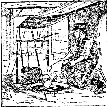
1. L'étameur recouvre d'étain les objets de fer : il fait ainsi du fer-blanc .
