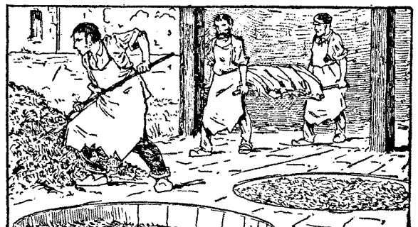
42. On les laisse ensuite séjourner plusieurs mois dans des cuves pleines de tan. Elles sont alors devenues du cuir.
